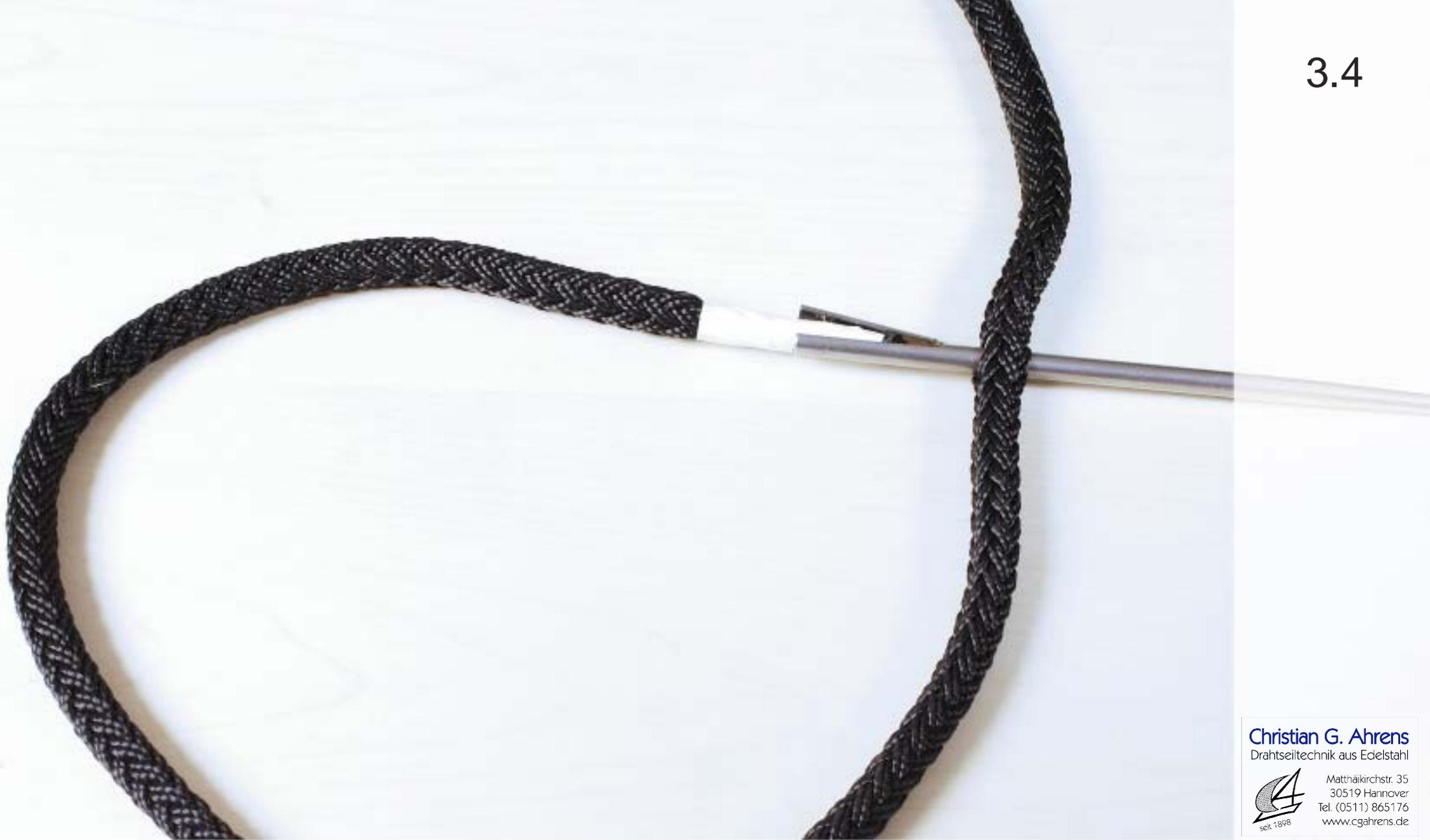
Nach einer Länge von  $40 \times$  Seildurchmesser + gewünschte Auglänge das abgeklebte Ende mit Hilfe des Profispleißers durchstecken.
