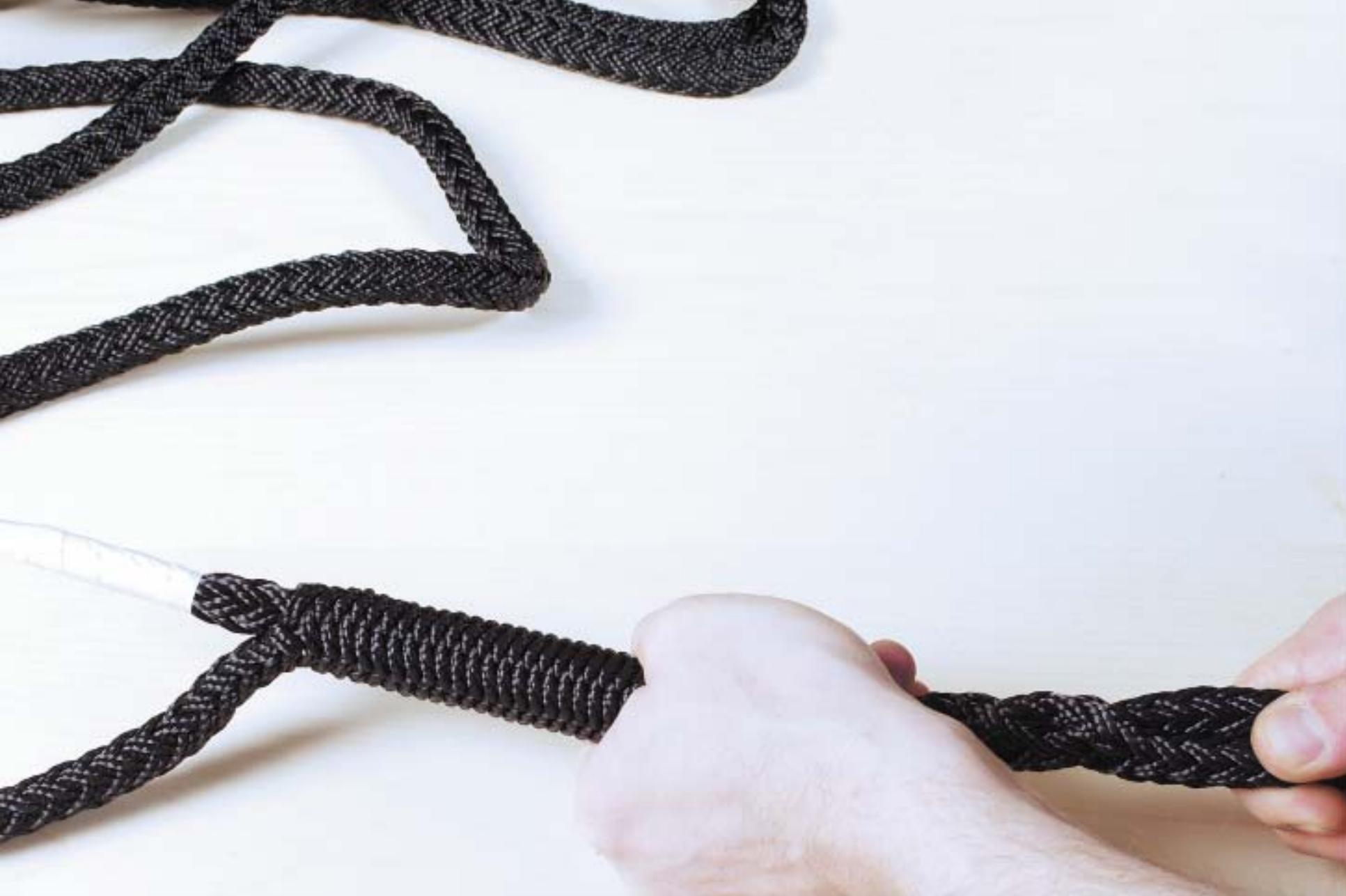
Tape entfernen und Geflecht leicht verjüngen. Geflecht über das eingespleißte Seilende melken, so dass dieses komplett in dem Seil verschwindet.
