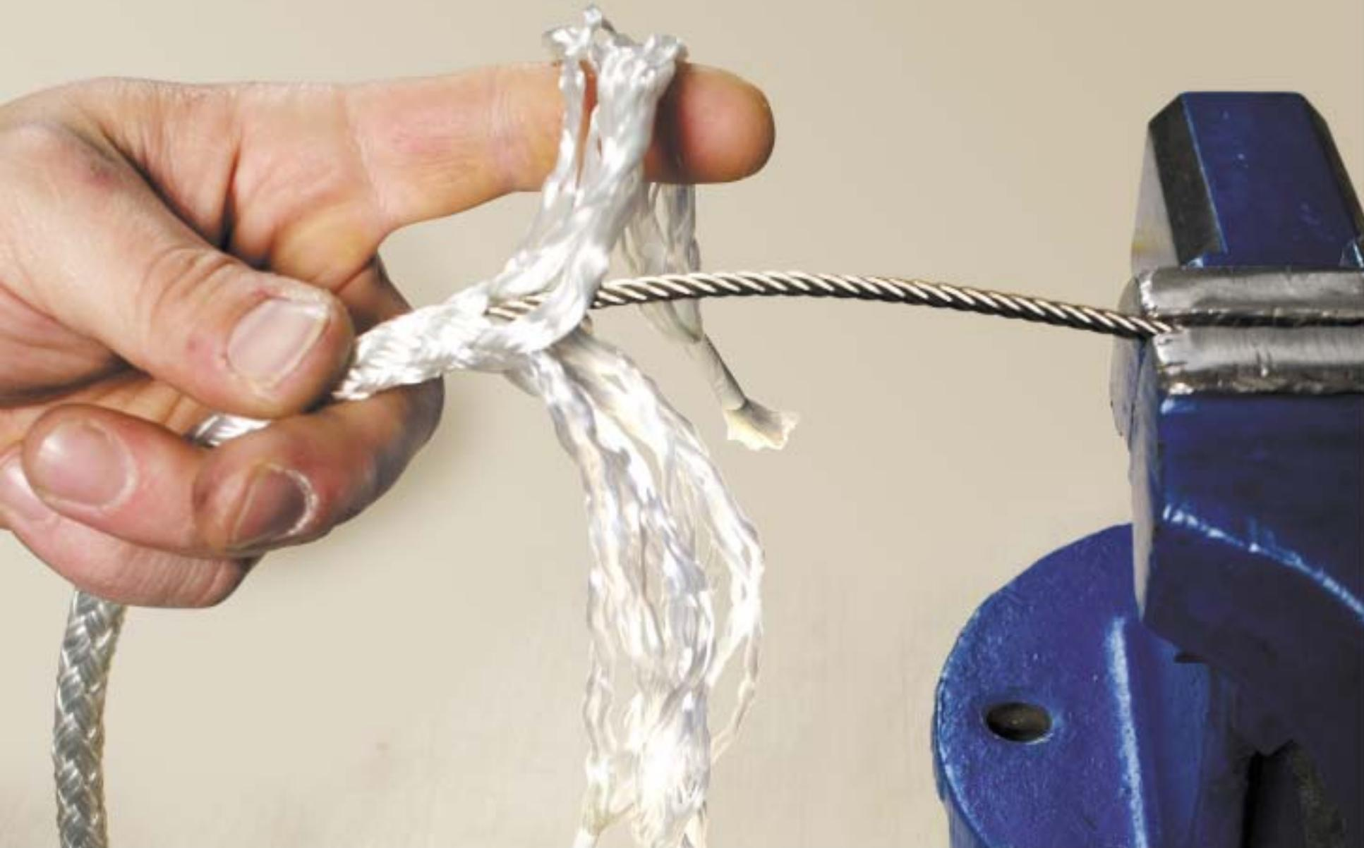
Drahtende im Schraubstock einspannen, und dann 3 etwa Gleichgroße Litzen aus dem ca. 15 cm geöffnetem Geflecht bilden.
