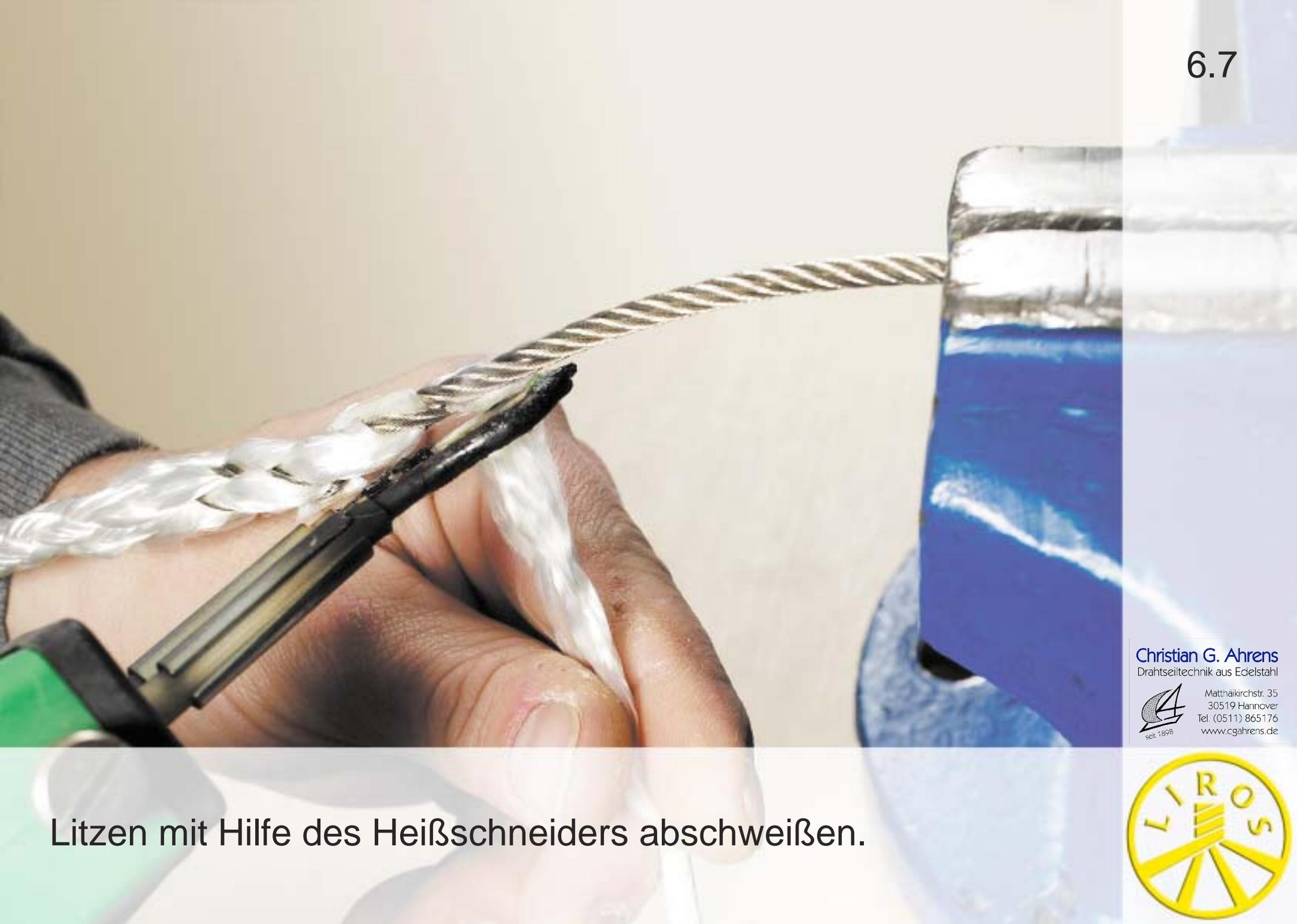
Litzen mit Hilfe des Heißschneiders abschweißen.
